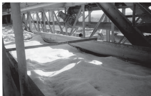
Фото E Лотковый транспортер из TIVAR® 88-2 в работе. До сегодняшних дней не обнаружено ни единого признака изнашивания или коррозии.
