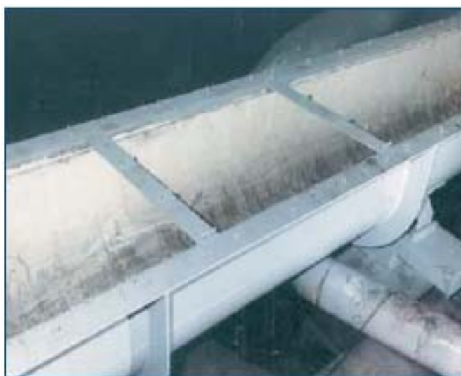
Транспортировочный желоб для угольной суспензии со значением pH: 2 - 3 Эксплуатационный период: Марганцевая сталь < 1 года, керамика > 8 лет
