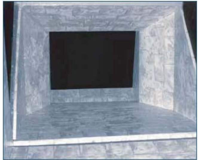
Ворончатая труба для загрузки скиповой тележки (Высокое количество ударного износа)
