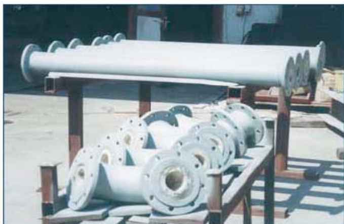
Сегменты трубы для ТЭС, перед сборкой. Срок эксплуатации: базальтовое литьё < 1 года, керамика > 5 лет
