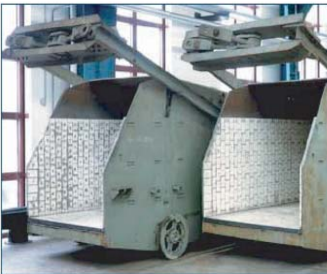
Скиповые тележки для загрузки доменной печи. Высокое количество ударного износа. Требуемый период эксплуатации > 5 лет завершен
