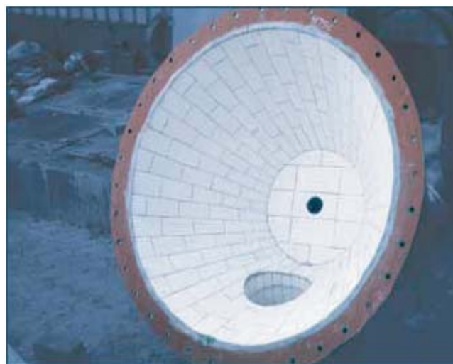
Лоток миксера для разгрузки агрессивных суспензий
