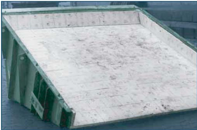
Вибропитатель (металлургический завод) шестикратный период эксплуатации по сравнению с твердой сталью
