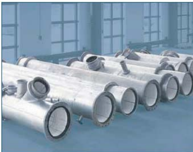
Трубы гидротранспортировки с выходными отверстиями покрытыми керамической мозаикой, вулканизированной резиной
