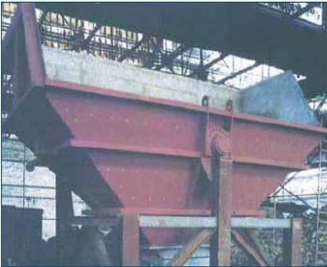
Передающая воронка, эксплуатационный период на текущий момент 6 лет
