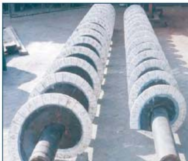
Защита кромки скребкового конвейера для транспортировки абразивной гидросмеси
